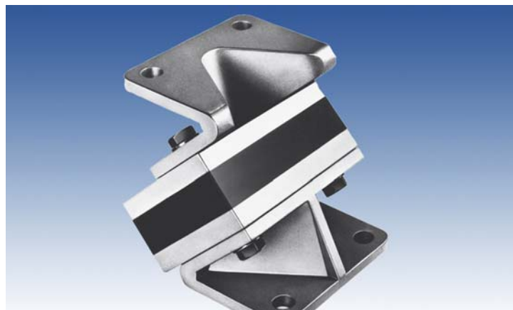
Bügel-Elemente sind geeignet um Wellenenden elastisch auf ebenen Flächen zu befestigen. Das Element erlaubt axiale, radiale, torsionale und kardanische Bewegungen, jeweils mit einer eigenen Federsteifigkeit.
