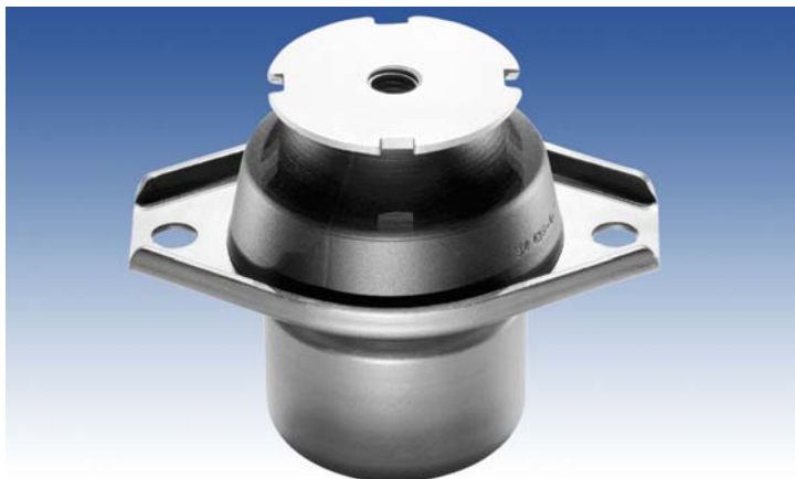
Hydrolager Serie V. Diese Baugruppe ist für Lasten von 20 bis 350 kg geeignet und ist besonders da interessant, wo neben Vibrationen störende Stösse auftreten und die Eigenschwingungen des Systems rasch abklingen sollen.
