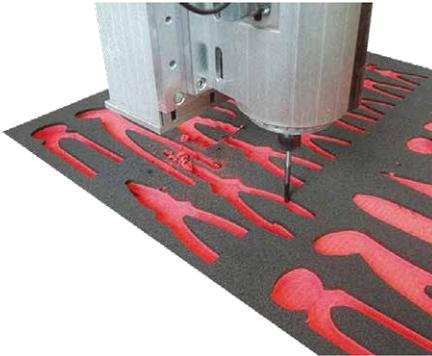
Die PE Schaumstoffeinlagen in den Farben Rot, Blau, Grün, Gelb oder Grau werden aus Schaumstoffblöcken auf die gewünschte Dicke gespalten. Danach kann die schwarze PE- Deckschicht mittels einer Laminiermaschine aufgebracht werden, damit eine Kontrastfarbe entsteht und somit die Visibilität und das Erkennen von fehlenden Werkzeugen vereinfacht wird.
